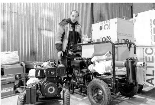
Павел Глушнев показывает вакуумную установку и перекачивающую станцию, которые весной займут свое место в прицепе новой машины. Также в комплексе – мобильный парогенератор
